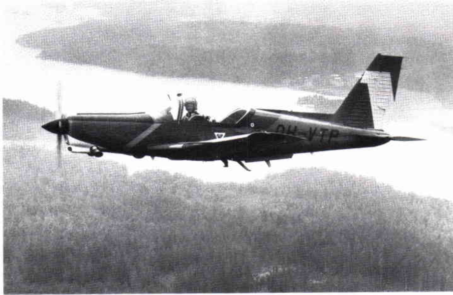
Skolflygplanet L-90 TP Redigo från finska Valmet har fått ett nytt motoralternativ nämligen en fransk Turbomeca TP-319 motor på 368 kW (500 hk).
