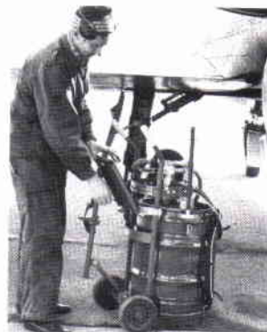
Aggregat för fyllning av startvätska 60-talet
