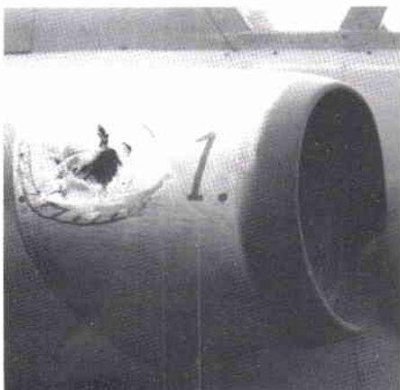
Skada i luftintag av glasfiberarmerad plast. Skadan har slipats jämn innan ny glasfiberväv + nytt plastskikt ska läggas på.
