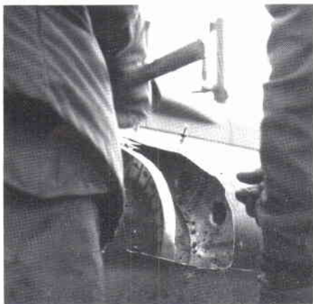
Strukturskada. Ny stringer och nytt spant monterade i plåtskarv.
